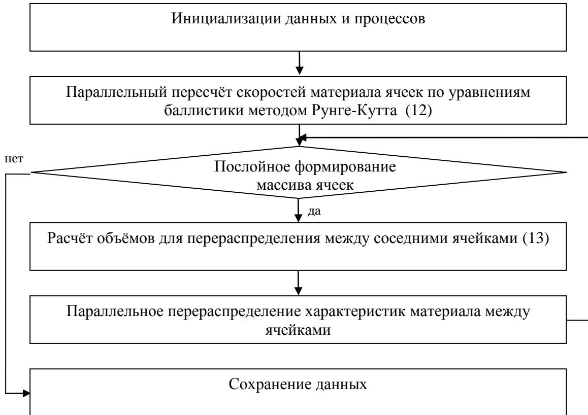
Рис. 4. Блок-схема алгоритма расчёта характеристик разрушенного материала при перемещении по баллистической траектории
