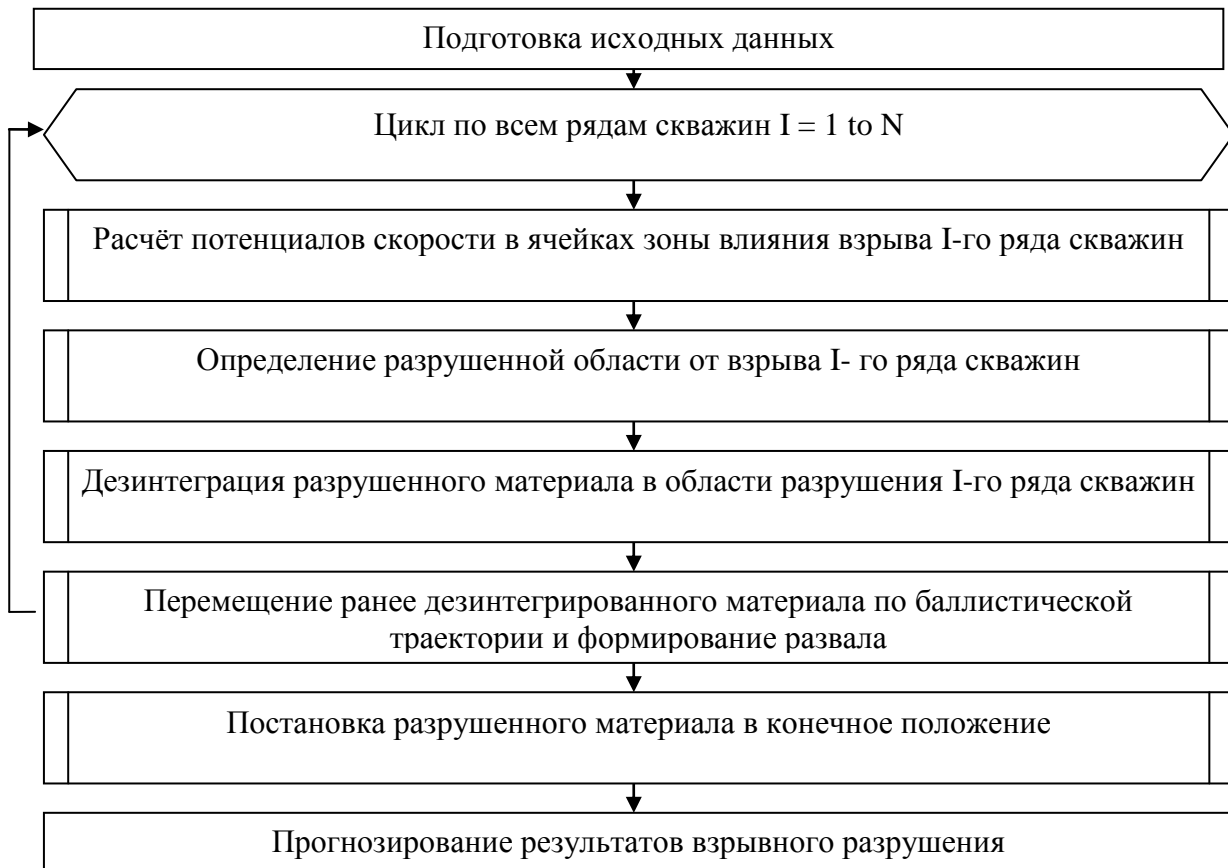
Рис. 1. Блок-схема общего алгоритма прогнозирования результата в взрывном разрушении при многорядном короткозамедленном взрывании
